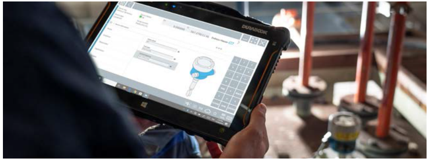
Heartbeat Technology により、モバイルデバイスを紹介した Liquiphant の検証が可能
