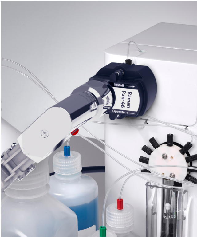
Sartorius社製のAmbr® 15およびAmbr® 250用のBioPAT® Spectroと接続されたRaman Rxn-46プローブ
