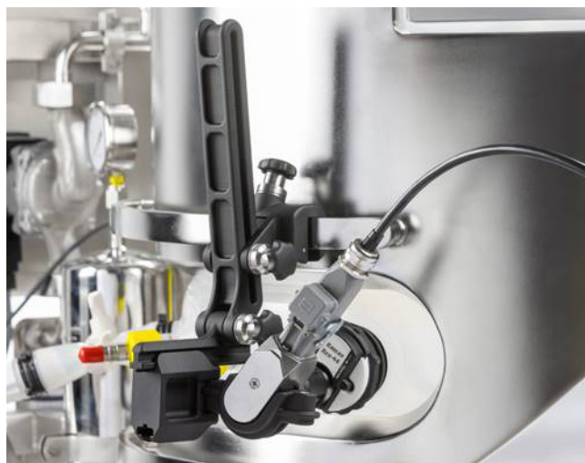
Sartorius社製のBioPAT® Spectroシングルユースポートを備えたBiostat STR® に接続されたRaman Rxn-46プローブ
